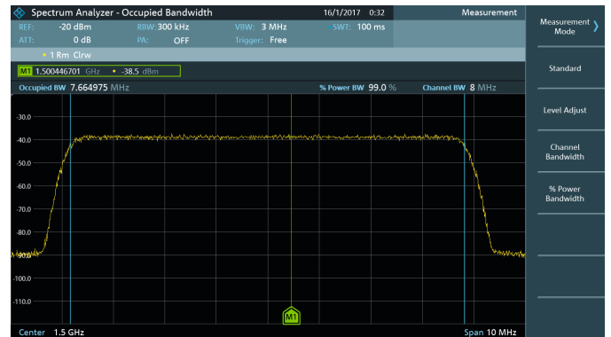
R&S®FPC-K55 : mesure de la largeur de bande occupée.
