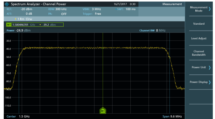
R&S®FPC-K55 : mesure de la puissance de canal.
