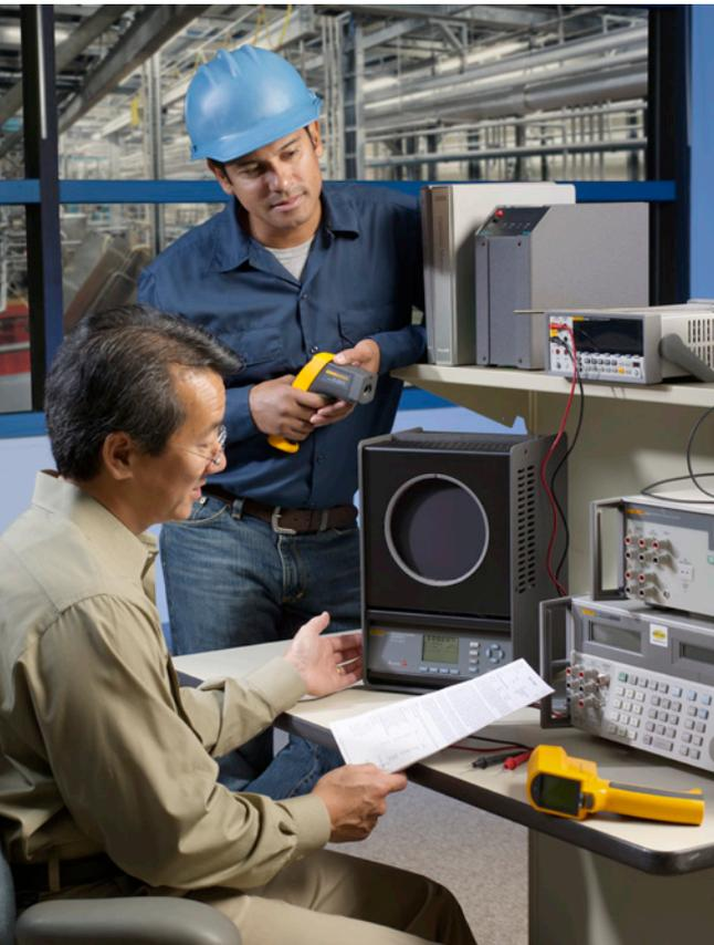
Les thermomètres infrarouges permettent de mesurer la température de surface d'une cible à une certaine distance sans la toucher physiquement. C'est vraiment un jeu d'enfant de simplement viser et pointer sur une cible pour mesurer sa température. Cette note d'application démystifie la thermométrie infrarouge (ou « IR ») en expliquant pourquoi un étalonnage régulier est important pour rentabiliser au maximum ces appareils.
